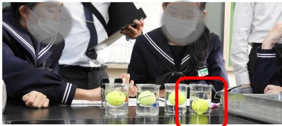
左から食塩水30, 20%, 砂糖水30, 20% 赤枠内の砂糖の20%のみ、ボールが沈む
