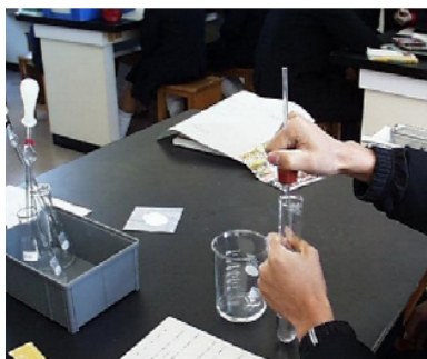
写真2 簡易冷却管をつけるところ
