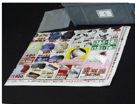
写真4 酢酸エチルで印刷を消したところ
