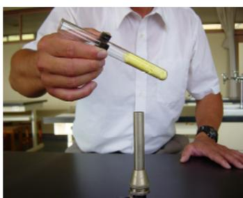
写真3 硫黄の加熱の仕方
