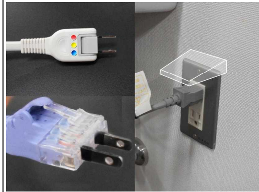
生徒のアイデアをCG化したもの。「熱が発生するとLEDがついて知らせる」、「LANケーブルのようにツメがある」、「コンセントにふたがついている」など
