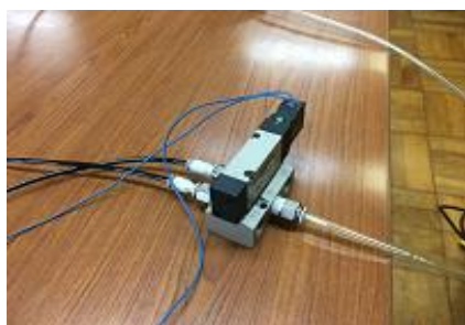
電磁弁によって、エアシリンダとアクチュエータを制御
