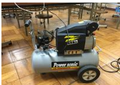
エアコンプレッサでつくられたエアをタンクに充填
