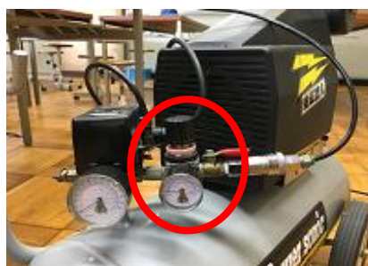
レギュレータによって、動作圧力に設定
