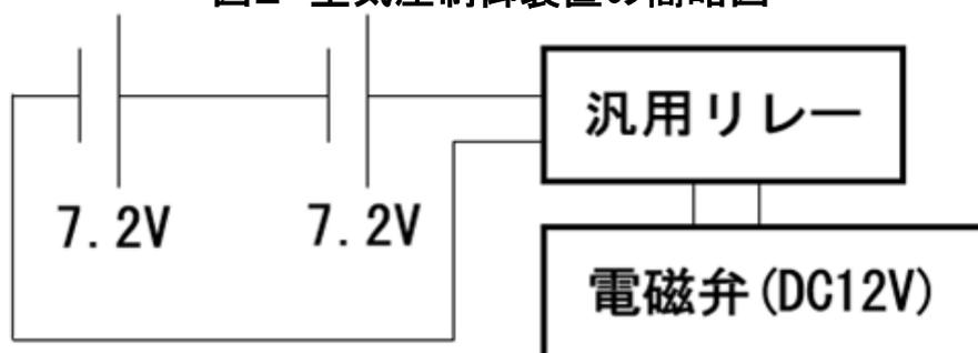
※ラジコン用DC7.2Vのバッテリー2個を直列接続することで、DC12Vの電磁弁を制御することができる。
