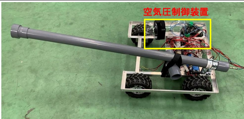
写真1 完成したロボット
