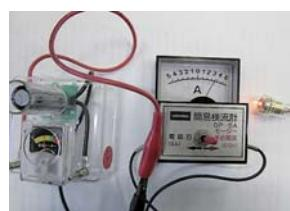
7 豆電球を豆電球型低電圧LEDに変えて、電流の値を調べる。
