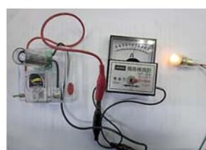
〔結果〕豆電球型低電圧LEDのほうが豆電球に比べ、点灯時間が長く、使われる電気の量が少ない。
